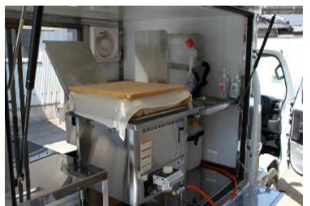
車の荷台に設置した蒸し器
